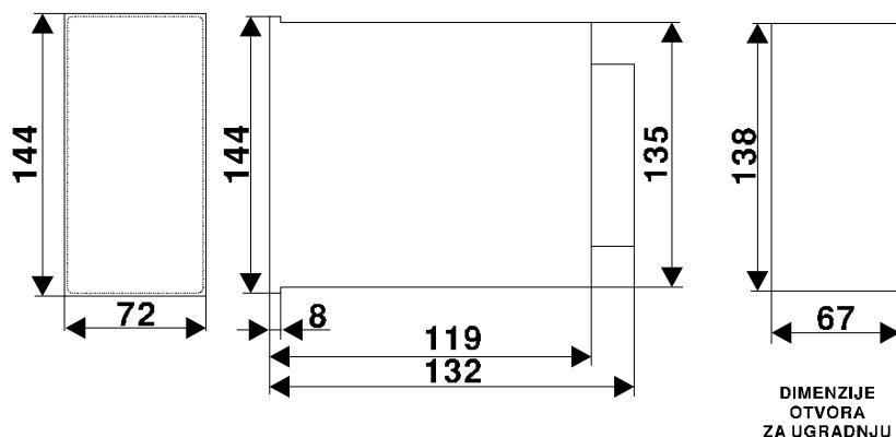
Kućište 144 x 72 mm
