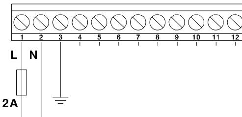
Radi zaštite uređaja od električkih smetnji iz okoline potrebno je na sve potencijalne izvore smetnji postaviti zaštitne elemente (RC članove na kontakte, a varistore na induktivna trošila). Vodovi napajanja moraju biti odvojeni od ulaznih vodova.
