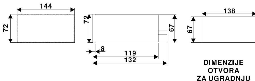
Kućište 72 x 144 mm
